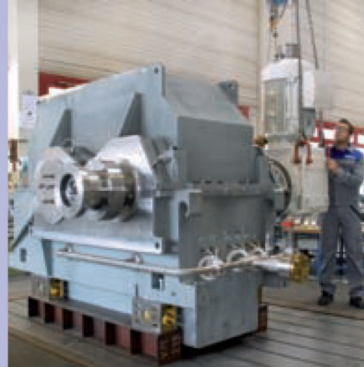
Серия F, тип FD 89-2 (19 МВт) с установленным устройством вращения ротора, для установки между газорасширительной турбиной и генератором, установка платино-глиноземной катализации
