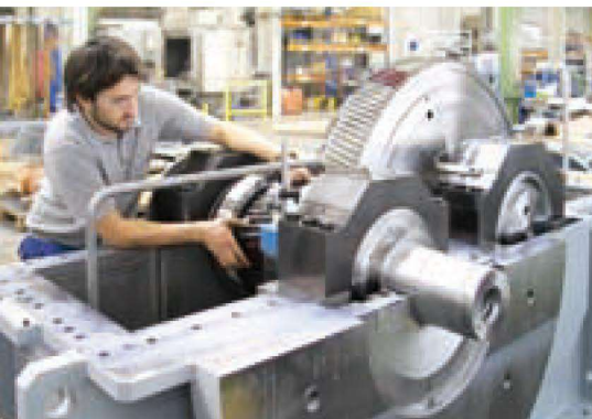
Одновальная серия TG, тип TGC 72 (14,5 МВт) для геотермальной электростанции в США, установлен между газорасширительной турбиной и генератором
