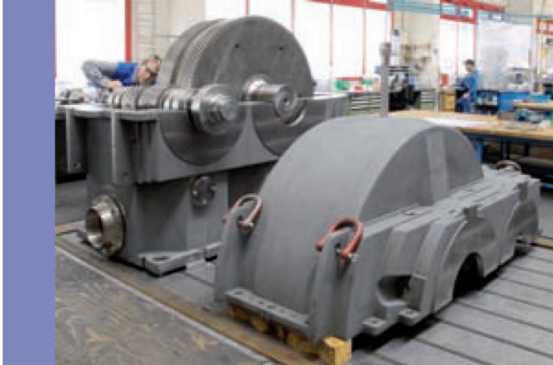
Серия Н, тип HD 80-2, для привода компрессора на трубопроводе природного газа мощностью 20,0 МВт, Россия
