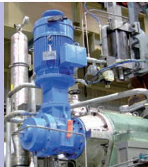
Тип RDV 80 с обгонной муфтой на свободном конце вала компрессора ( n = 316 об/мин., BAT^* = 1663 Н•м, 138 кг м 2 )
