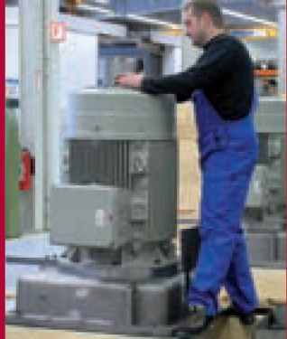
Устройство вращения роторов с откидной шестерней, размер 5, с автоматическим режимом 3 ( n = 283 об/мин, BAT^* = 6000 Н•м, MOI^* = 4856 кг м 2 )
