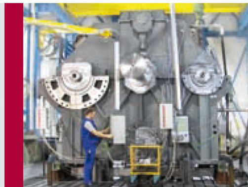
Редуктор серии WG, тип WGC 5-330T (31,5 МВт) перед испытательным прогоном на испытательном стенде
