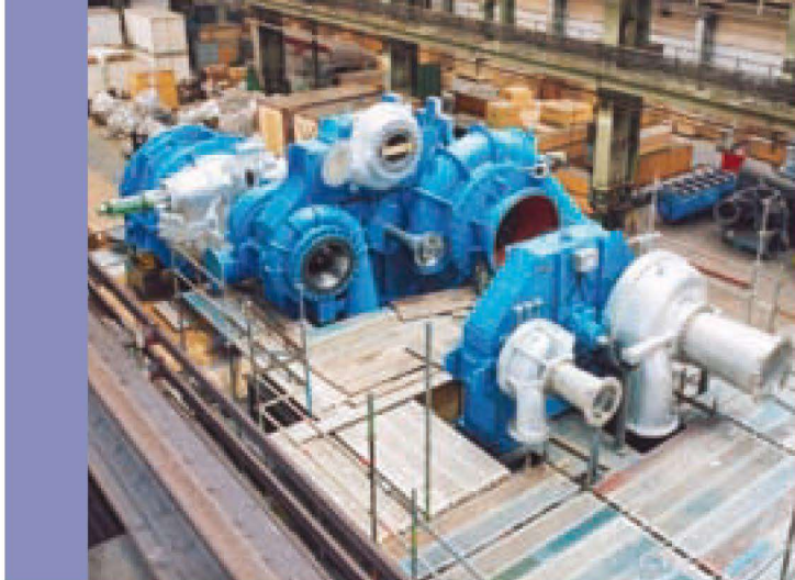
Тип WGC 3-220 (11 МВт) и WGC 5-330T (23,5 МВт) на испытательном стенде изготовителя установки Фото предоставлено MAN Turbo AG, Оберхаузен
