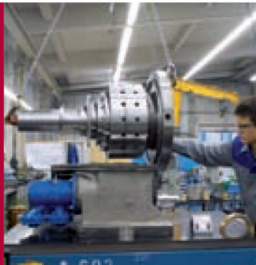
Серия RT, тип RTP 25 (3,5 МВт) для компрессора электростанции на Балканах
