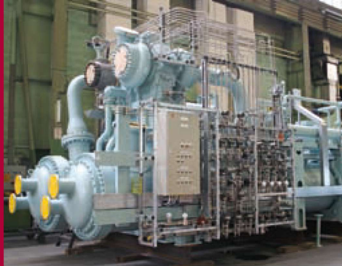
Редукторный компрессор с интегральным редуктором типа WGC 3-110 (5,4 МВт) для сжижения испаряющегося природного газа на танкерах для перевозки сжиженного газа Фото предоставлено Atlas Copco Energas, Кёльн
