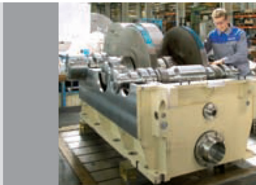
Серия В, тип BD 140, передаточное число 20:1, мощность 3 МВт, коэффициент API 2, для компрессоров природного газа, Ближний Восток
