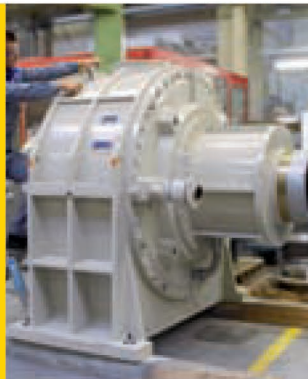
Серия RT, тип RTP 72K (16 МВт) для электростанции, перерабатывающей отходы биомассы в Латвии
