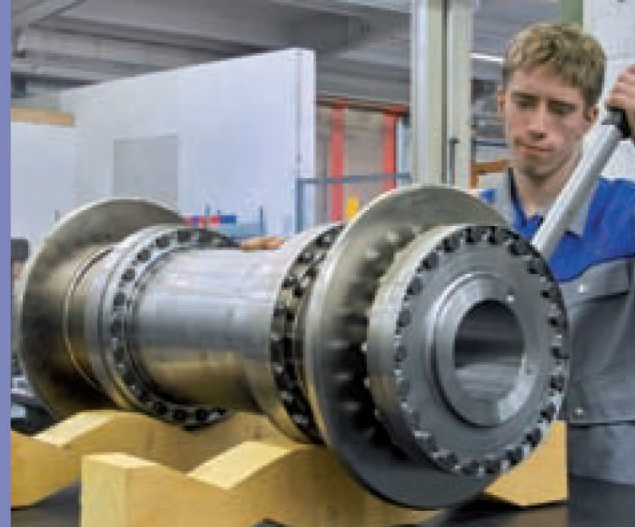
Муфта с двойной мембраной TwinTors типа MKB 300 IIS (максимальный крутящий момент 65800 Н•м, до 20 000 об/мин, 64,9 кг) с внутренней ступицей для передачи пониженного момента, предназначена для установки между паровой турбиной и компрессором для окислов азота
