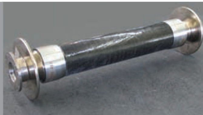
Муфта с двойной мембраной TwinTors типа MKB 160 FFS с сваренной втулкой из пластика, армированного углеродным волокном (максимальный момент 6040 Н•м, до 30 000 об/мин, 6,4 кг)
