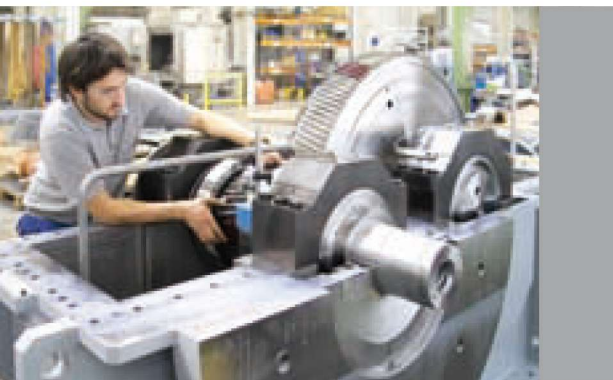
Одновальная серия TG, тип TGC 72 (14,5 МВт) для геотермальной электростанции в США, установлен между газорасширительной турбиной и генератором
