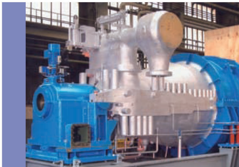
Тип RDV 2A1 с откидной шестерней на подшипниковой опоре паровой турбины ( n = 42 об/мин, BAT^* = 715 Н•м, 2860 кг м 2 )
