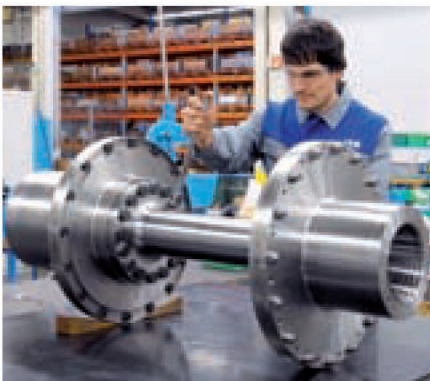
Однодисковая мембранная муфта EconTors типа MKS 450 AAS (максимальный крутящий момент 183 000 Н•м, максимальная частота вращения 5 500 об/мин, 321,5 кг), предназначена для установки между электродвигателем и Vorecon
