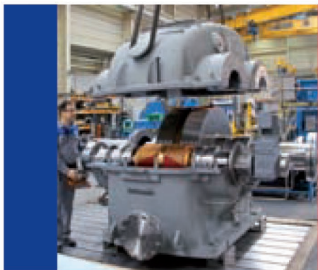
Серия А, тип AD 80-3, для передачи мощности 37 МВт, установка для разделения воздуха, Китай
