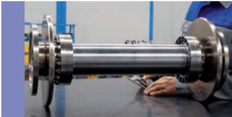
Муфта с двойной мембраной TwinTors muна MKA 300 FFS (максимальный крутящий момент 43808 Н·м, до 20000 об/мин, 37,6 кг) для установки между редуктором и турбиной
