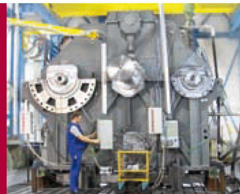
Редуктор серии WG, тип WGC 5-330T (31,5 МВт) перед испытательным прогоном на испытательном стенде
