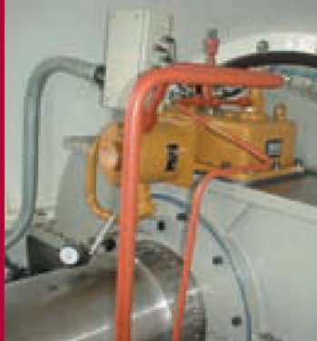
Тип RVD 3 HSO ( n = 283 об/мин, BAT^* = 6000 Н•м, MOI^* = 4856 кг м 2 ) с гидромотором, устанавливаемый на подшипниковую опору газовой турбины
