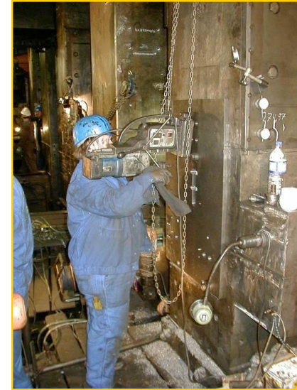
Нарезка резьбы с помощью шаблона
