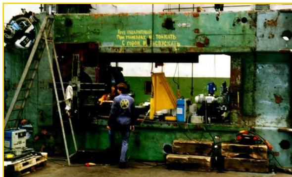
▲ Поверхность ползуна пресса после капитального ремонта
