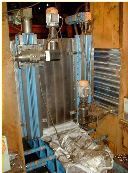
Работа фрезерной установки по обработке станины прокатной клетки
