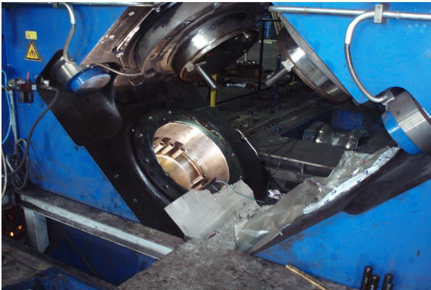
Трещина в цилиндре
