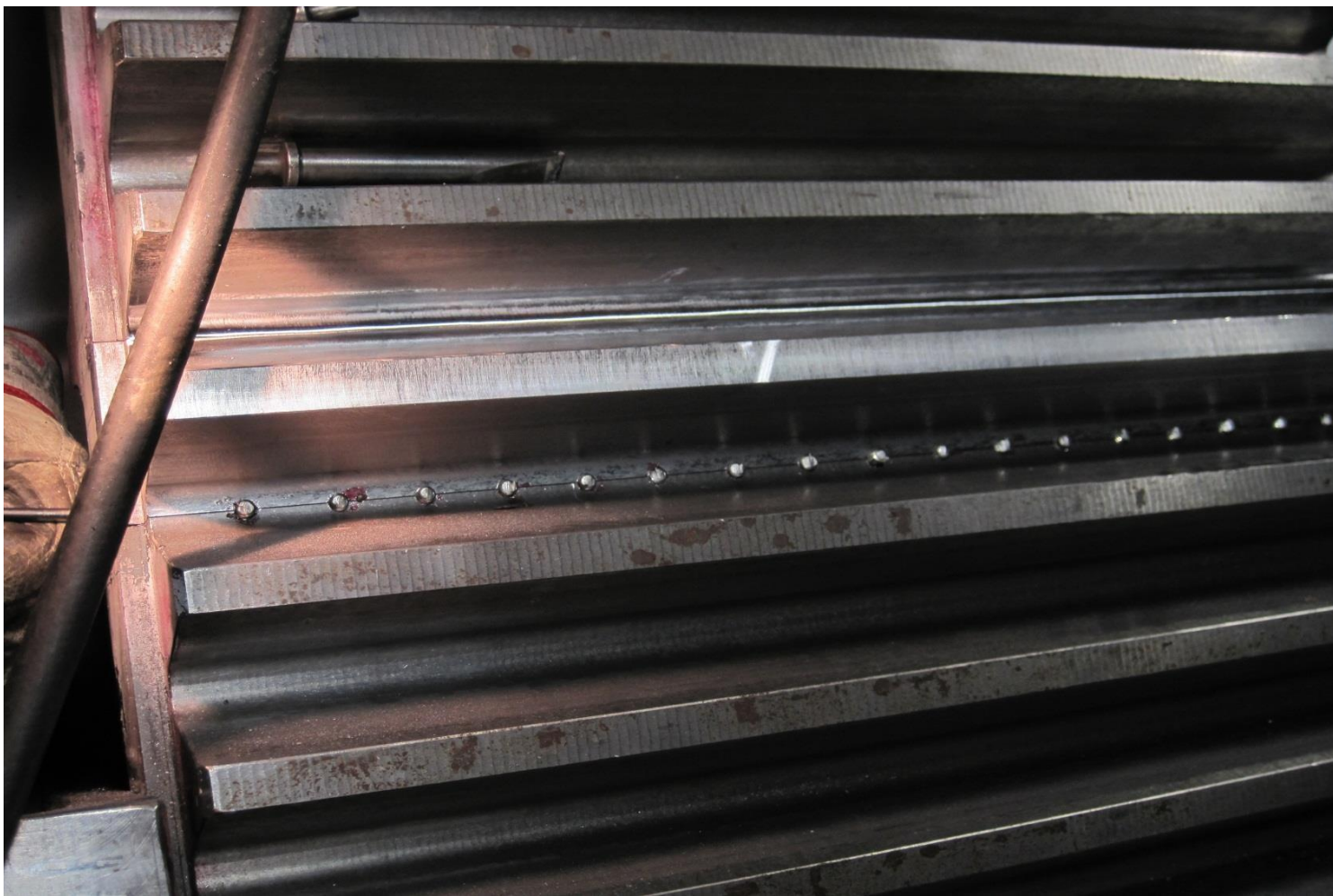
Крепление зуба методом «Металок»
