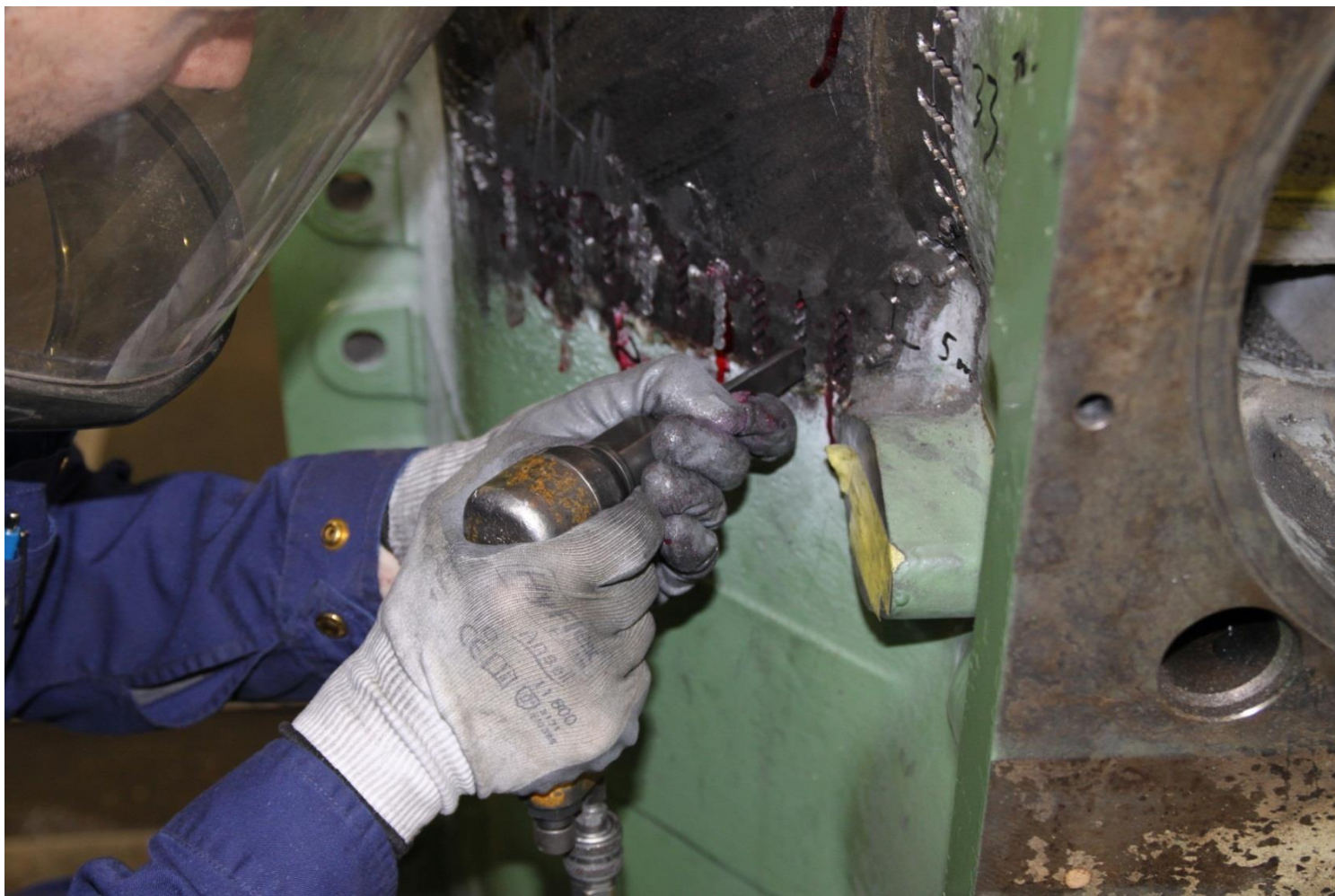
Вбиваем вставки с помощью пневмомолотка
