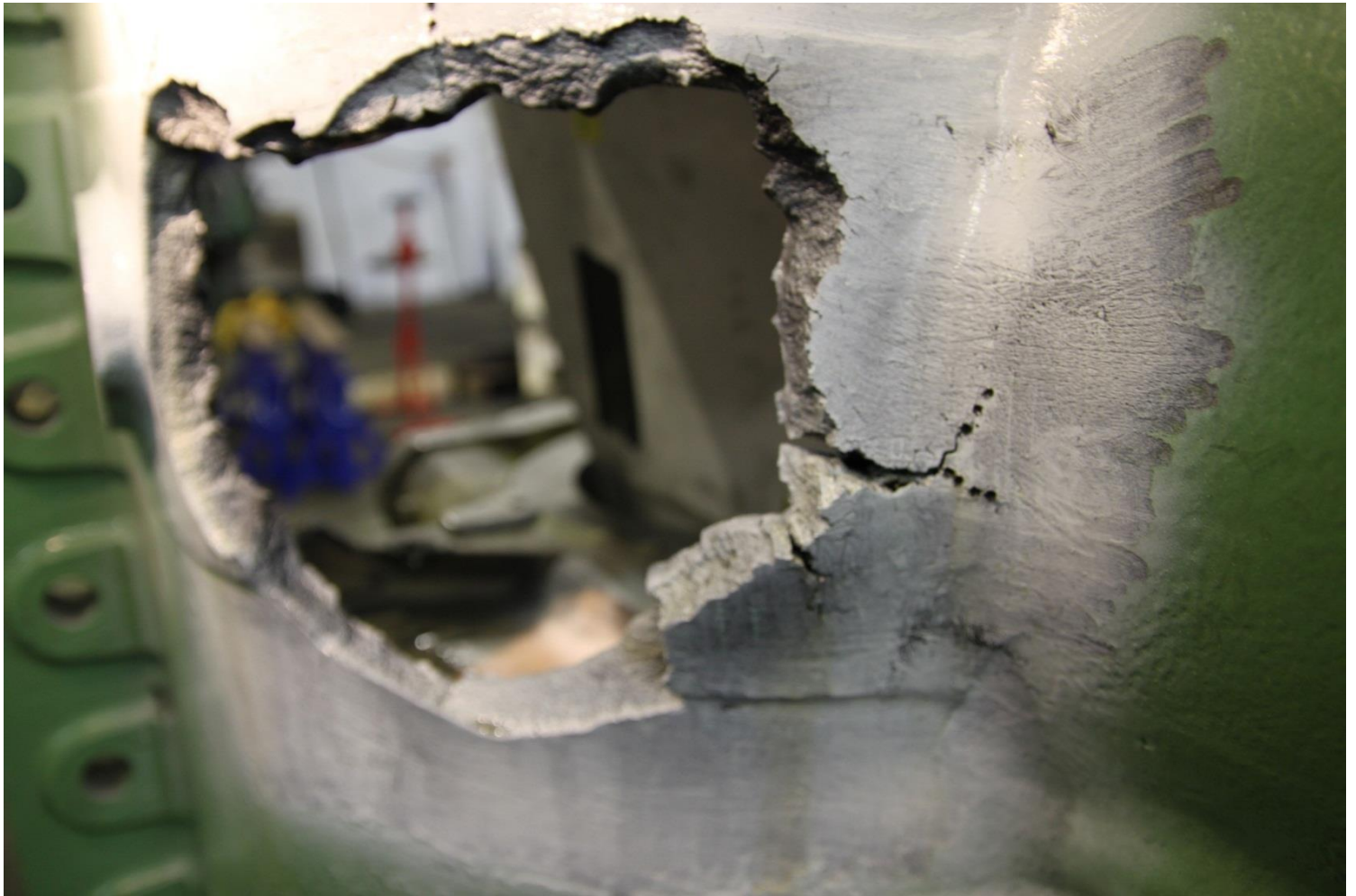
Дефектоскопия пробоины и трещин вокруг
