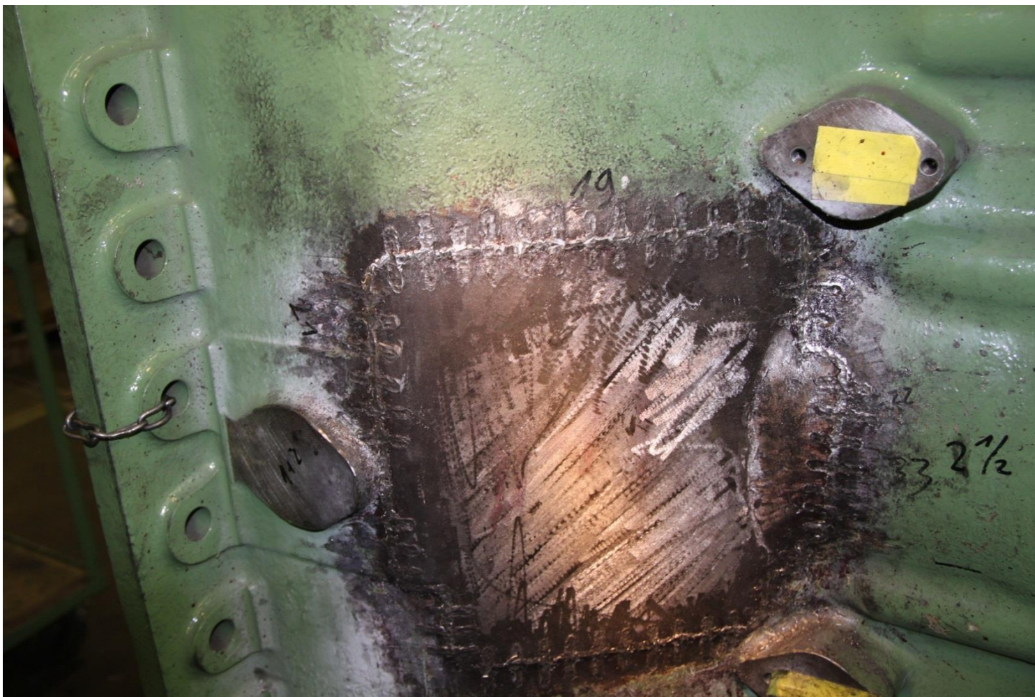
Готовый ремонт после установки вставок и штифтов
