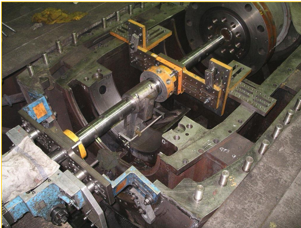
Растачивание гнезда подшипника сферической формы с помощью сверлильного вала Ø100 мм
